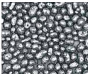
Bild 3: Betriebsgemisch Stahl-Strahlmittel Ferroplus
