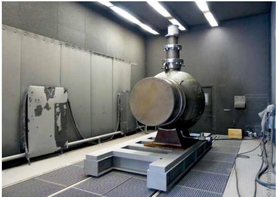
Bild 1: Kugelhahn mit einem Durchmesser von 1,4 m in der Druckluft-Freistrahlanlage
